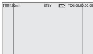
Wenn Sie „Aspect Marker“ auf „Mask“ stellen, können Sie außerdem mit „Aspect Mask“ die Helligkeit des Bilds außerhalb der Bildformatmarkierung einstellen. Hierbei kann aus einem Bereich zwischen 0 % und 90 % ausgewählt werden (in Schritten von 10 %).
