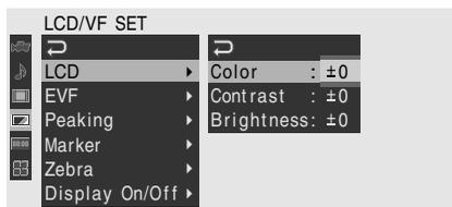
Stellen Sie Farbe, Kontrast und Helligkeit des LCD-Monitors mit den entsprechenden Optionen des LCD-Menüs ein: Color, Contrast und Brightness.
